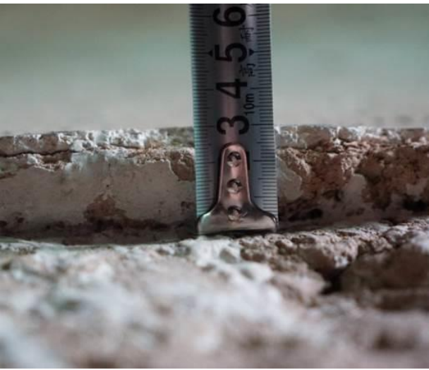
图 3-8 天宁寺大雄宝殿壁画地仗层厚度测量
