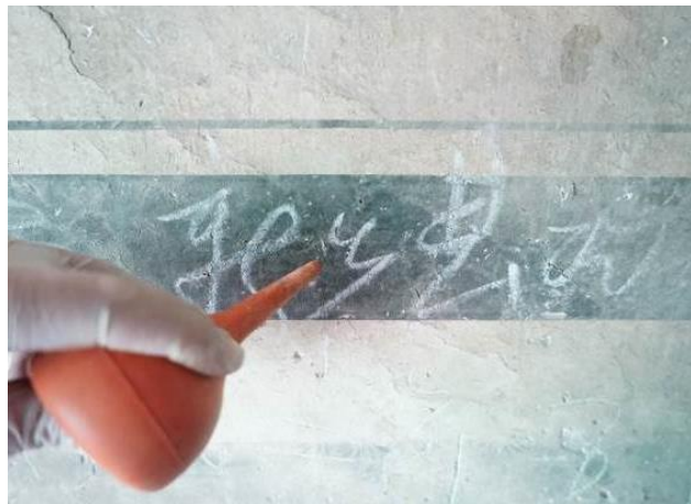
图 5-85 洗耳球轻吹表面浮尘
