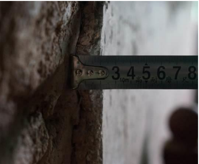
图 3-8 天宁寺大雄宝殿壁画地仗层厚度测量
