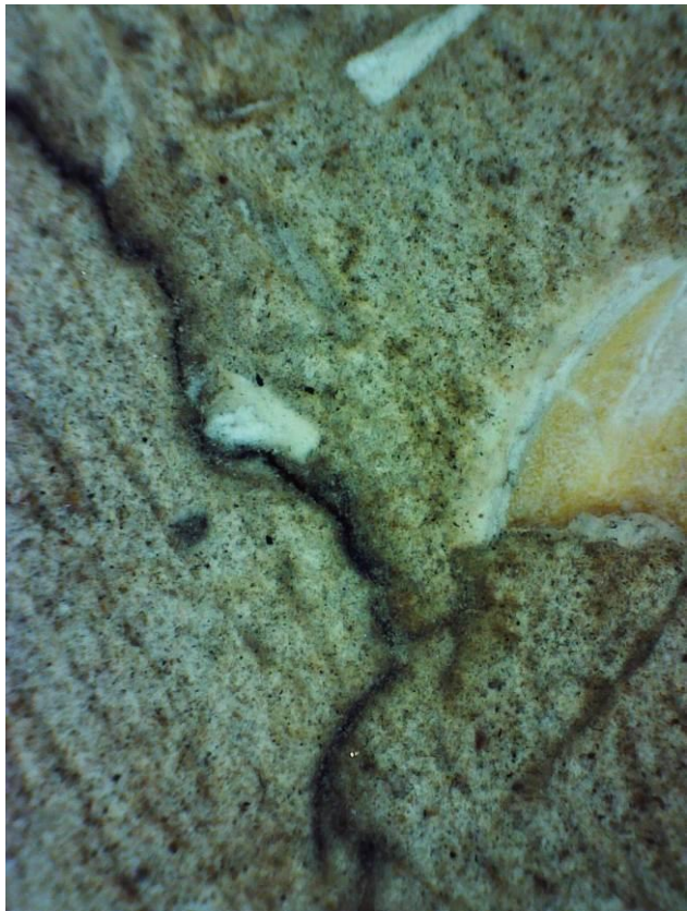
图 2-33 西壁局部龟裂显微照片（倍数 x60）
