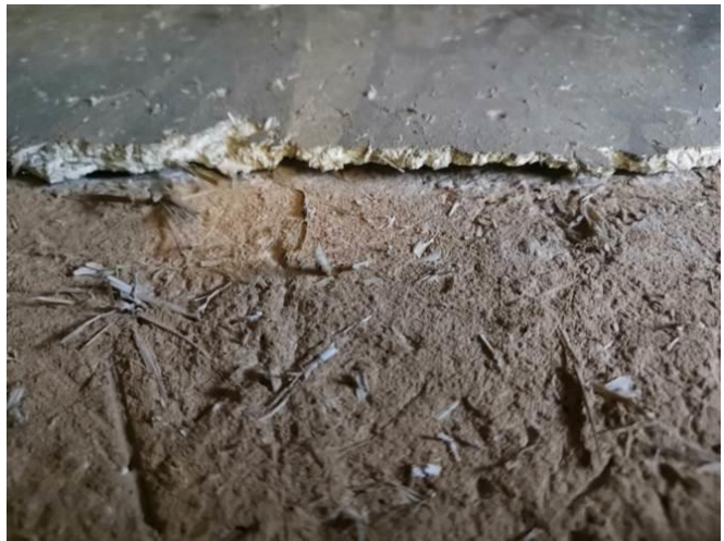
图 3-9 天宁寺大雄宝殿壁画白粉层中的纤维材料 图 3-10 天宁寺大雄宝殿壁画白粉层厚度测量
