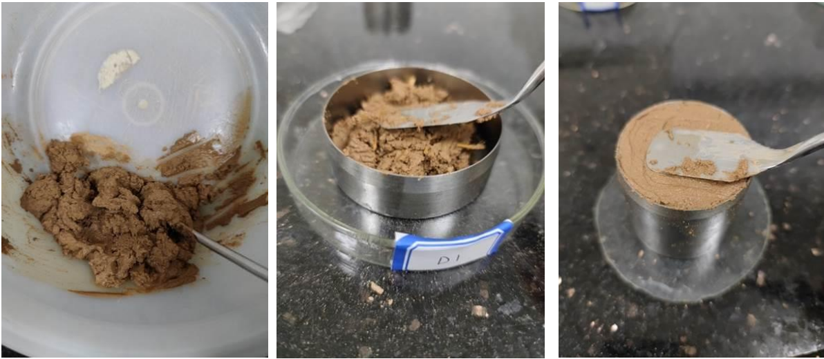
调配材料 放入模具 修整表面
