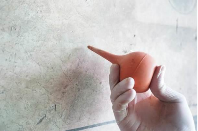
图 5-64 洗耳球轻吹表面浮尘
